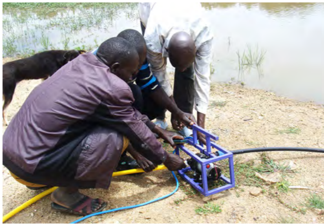
Oben: Gemeinsam testet die Gruppe COCOBA die neue solarbetriebene Mikro-Bewässerung, um Wasser auf die Felder auszubringen. Unten: Ally Naima (mit zwei ihrer sechs Kinder) und ihr Mann Ohogo Rajab hoffen, mit der neuen Pumpe ihre Ernten langfristig zu verbessern.
